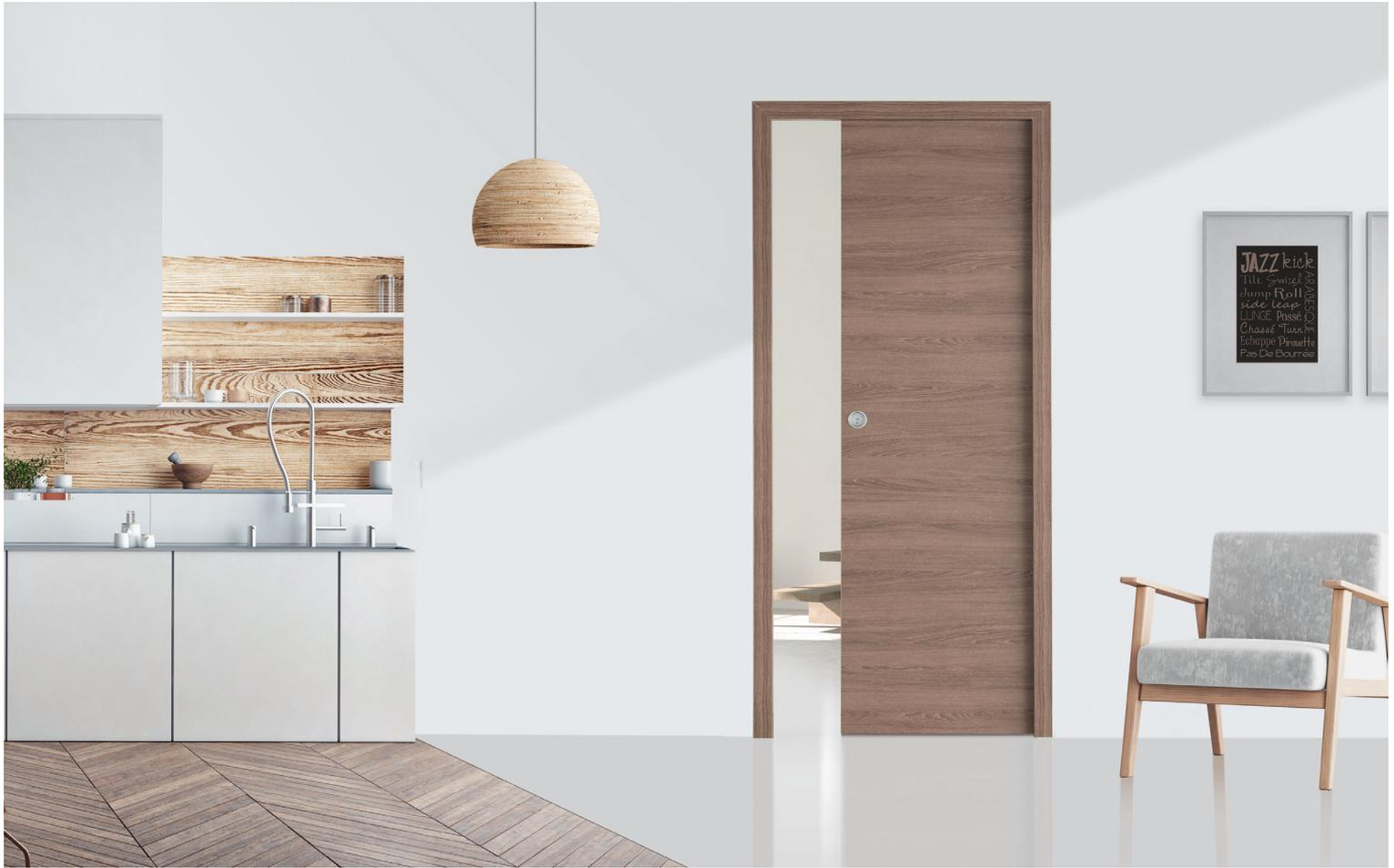
Le châssis à galandage apporte un avantage fonctionnel en faisant glisser la porte à l'intérieur de la cloison. Ce système permet d'optimiser l'espace en libérant environ 1 m<sup>2</sup> au sol correspondant au dégagement nécessaire d'une porte à débattement classique.
