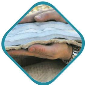
Isolants et pare-vapeur réflecteurs assurant l'étanchéité à l'air.
